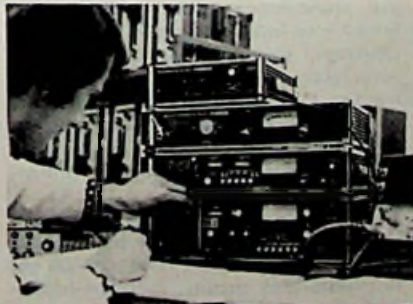
Afb. 10. Apparatuur voor de afregeling van mobilofons, fabriekaart Metrix .
