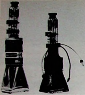
De kathodestraalbuis van de PM 3260 (rechts) is korter dan een vergelijkbare buis van een ouder type.
