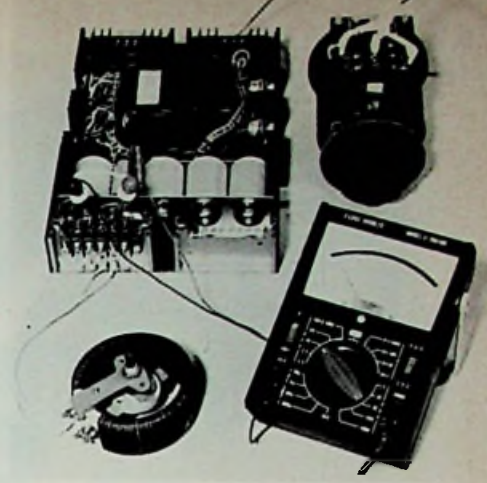
Enige testattributen bij de Slimpac 60: variac, belastingsweerstand en universele meter (50 kΩ/V).
